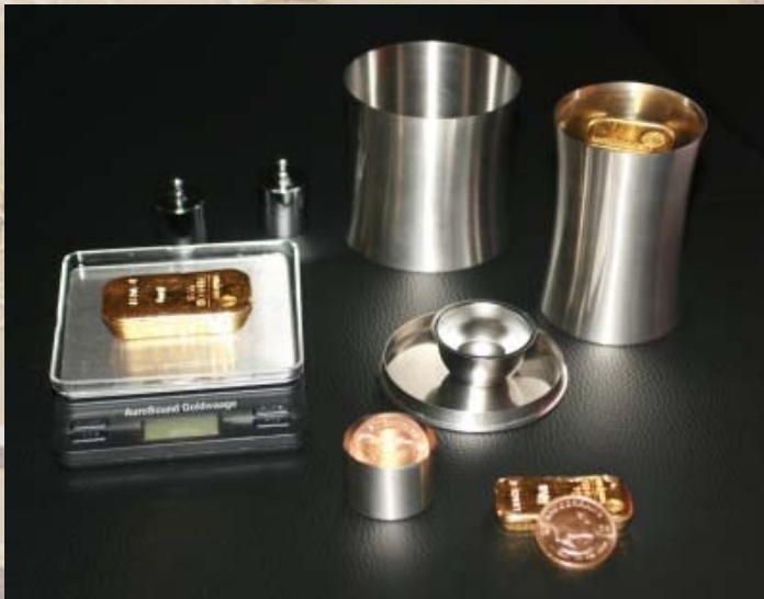
Dichtemessung mit einigen Meßgefäßen des Prüfsets ATS 1000 bei der Untersuchung von Goldbarren und -münzen
