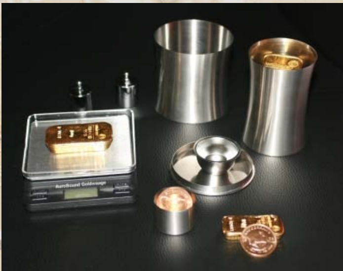
Dichtemessung mit einigen Meßgefäßen des Prüfsets ATS 2000 bei der Untersuchung von Goldbarren und -münzen. Größere Pyknometer-Meßbecher für die Dichtebestimmung von 5 kg Silber - sowie für 400 oz. Goldbarren sind ebenfalls in diesem Prüfset enthalten.
