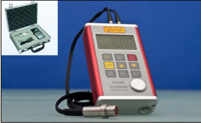
Digitales Ultraschallgeschwindigkeitsmeßgerät des Prüfsets ATS 2000, oben links: geöffneter Transportkoffer mit Teilen des Prüfsets (Ultraschall-Prüfkoffer)
