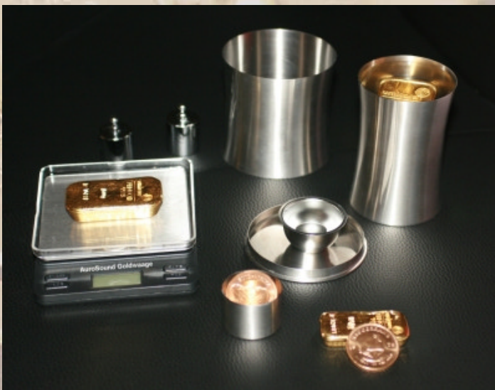
Dichtemessung mit einigen Meßgefäßen des Prüfsets ATS 3000 bei der Untersuchung von Goldbarren und -münzen
