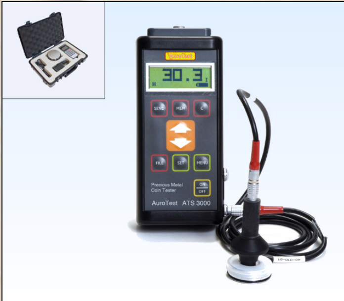
Digitales Wechselstromleitfähigkeitsmeßgerät des Prüfsets ATS 3000, oben links: geöffneter Transportkoffer mit Teilen des Prüfsets
